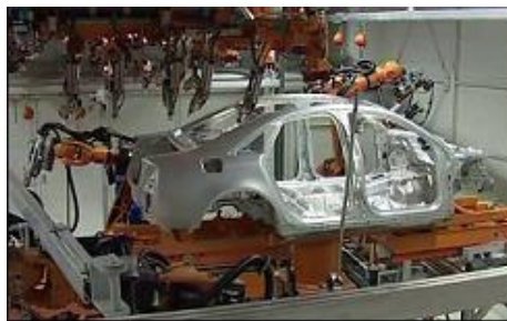
Soudage hybride de l'AUDI A8 (source AUDI)
